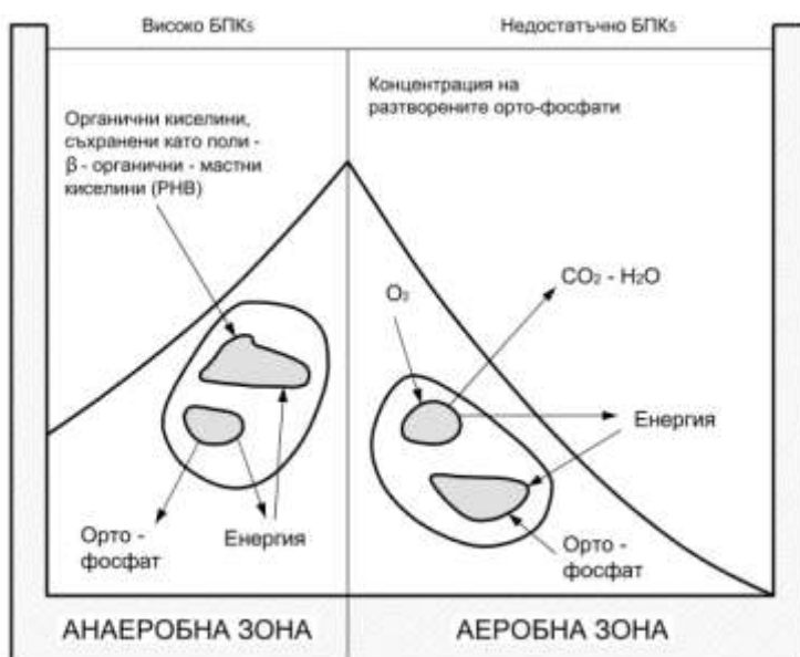
Фиг.8. Действие на фосфат акумулиращи бактерии и преминаване от аеробна в анаеробна среда
