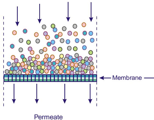
**Figure 2: Filtration membrane**
